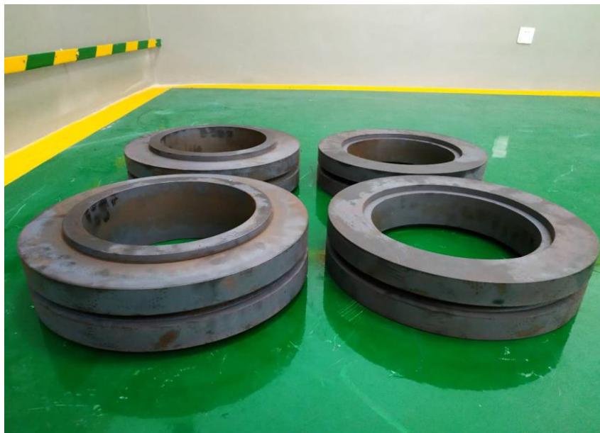
Рис. Детали-экструдеры из кованой стали 4Х4Н5М4Ф2 для горячего деформирования меди марки М1 (ГОСТ 859-2014). Изготовлена в Центре исследований и технологий ИПМ Нинбо и компанией Futec Co., Ltd (г. Нинхай, провинция Чжецзян, Китайская Народная Республика)
